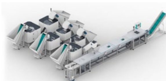
Confezionatrice automatica con film monopiega. Vertical automatic packaging machine with U-fold film.
